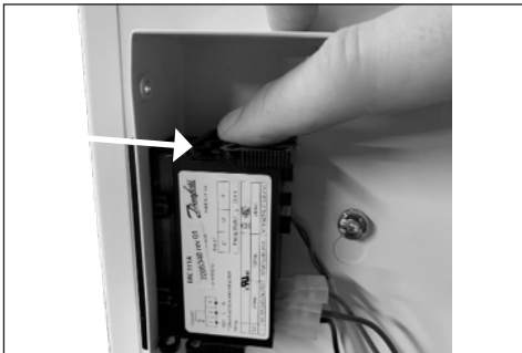
4: Utilice el dedo para presionar y deslizar la abrazadera superior hacia atrás para retirarla del cuerpo del termostato
