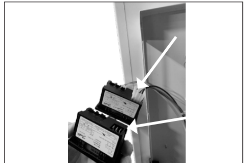
7: Cambie el enchufe del cable del sensor, de la toma antigua a la nueva
