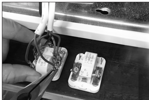
8. Use unos alicates de punta para extraer los conectores de cable del dispositivo de arranque.
