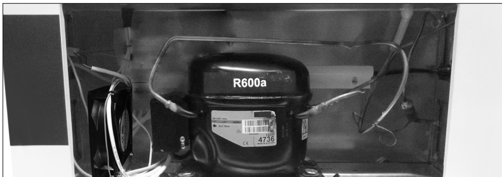
El dispositivo de arranque se monta en el lado izquierdo del compresor.
